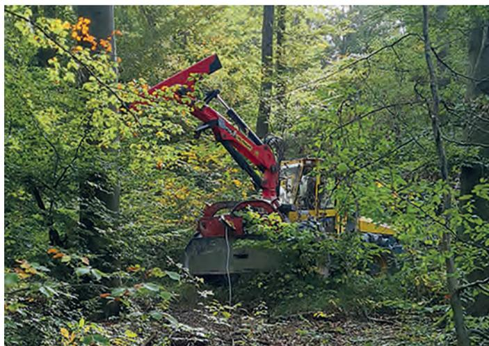
Ohne Maschinen geht bei der Holzernte nichts. Rückefahrzeug mit Kran und Seilwinde
