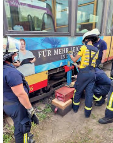
Anheben der Bahn mittels des Rettungssatz Schiene
