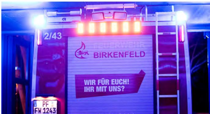
Am Heck des HLF 10 befindet sich zusätzlich zu den Blaulichtern noch eine sog. Verkehrswarnerichtung. Die orange blinkenden LED-Streifen dienen – zusätzlich neben Blaulicht und Warnblinker – zur Fahrzeugabsicherung und zur Warnung anderer Verkehrsteilnehmer an der Einsatzstelle.
