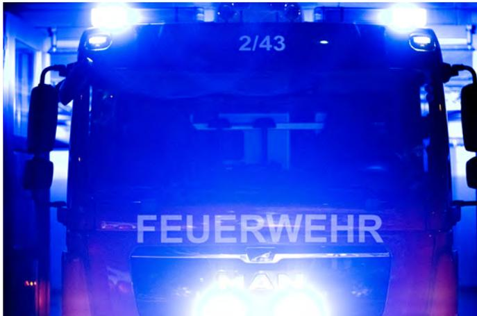
Alarmsignale am HLF 10 der Abteilung Gräfenhausen: Blaulichtanlage mit Horn auf dem Dach und Frontblitzer.
