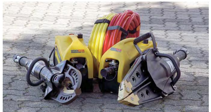
Rettungsschere (l.) und Rettungsspreizer (r.). Dazwischen handliche Elektroaggregate und Hydraulikschläuche.
